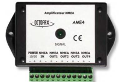
Cet appareil opto-isolé à l'entrée permet d'envoyer par exemple l'information NMEA du GPS vers plusieurs appareils (centrale de navigation, pilote automatique, VHF, cartographie PC...). La diode LED visualise la présence du signal.
