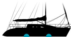
Positionnement conseillé des émetteurs SONIHULL Duo pour un voilier jusqu'à 17 mètres
