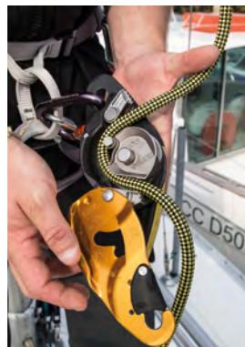
Positionnement de la corde **AXIS** dans le descendeur / assureur I'D S.
