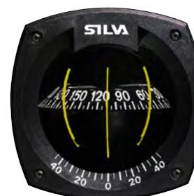
Compas équipé d'une graduation d'angle de gîte et d'un éclairage intégré. Deux alidades à 45°. Le globe ne dépasse que de 32 mm dans le cockpit.
