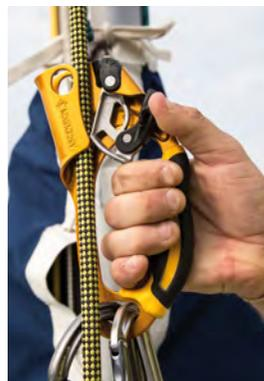
Positionnement de la poignée ascension sur la corde **AXIS** en amont du descendeur.
