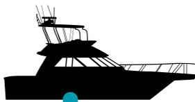
Positionnement conseillé de l'émetteur SONIHULL Mono pour une vedette jusqu'à 10 mètres
