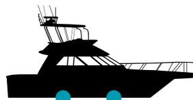
Positionnement conseillé des émetteurs SONIHULL Duo pour une vedette jusqu'à 17 mètres
