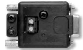
Ce convertisseur NMEA / RS-232 opto-isolé est intégré dans le boîtier SUB D 9 points et auto alimenté. Il permet d'envoyer l'information NMEA sur le port COM du PC en mettant le signal au bon niveau et en protégeant le port COM des risques électromagnétiques et de l'inversion des polarités (par opto coupleur).
